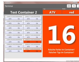
Beispiel: fehlerhafte Einlagerung
